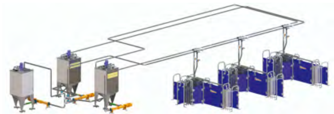
带 2 种饲料类型的 HydroMix 液态料饲喂系统功能示意图（需要 2 个储存罐和 2 条料线）
